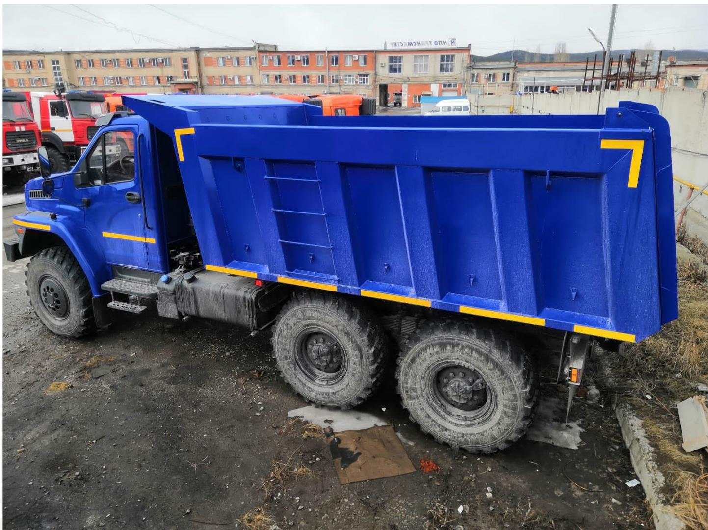
Самосвал с задней разгрузкой, 10 тн, 11,5 м<sup>3</sup>, задний борт, платформа коробчатого типа с обогревом, ПЭВ, ДЗК, 6х6, 273 л.с., дв. ЯМЗ-536, КП ЯМЗ, баки 300+180 л
