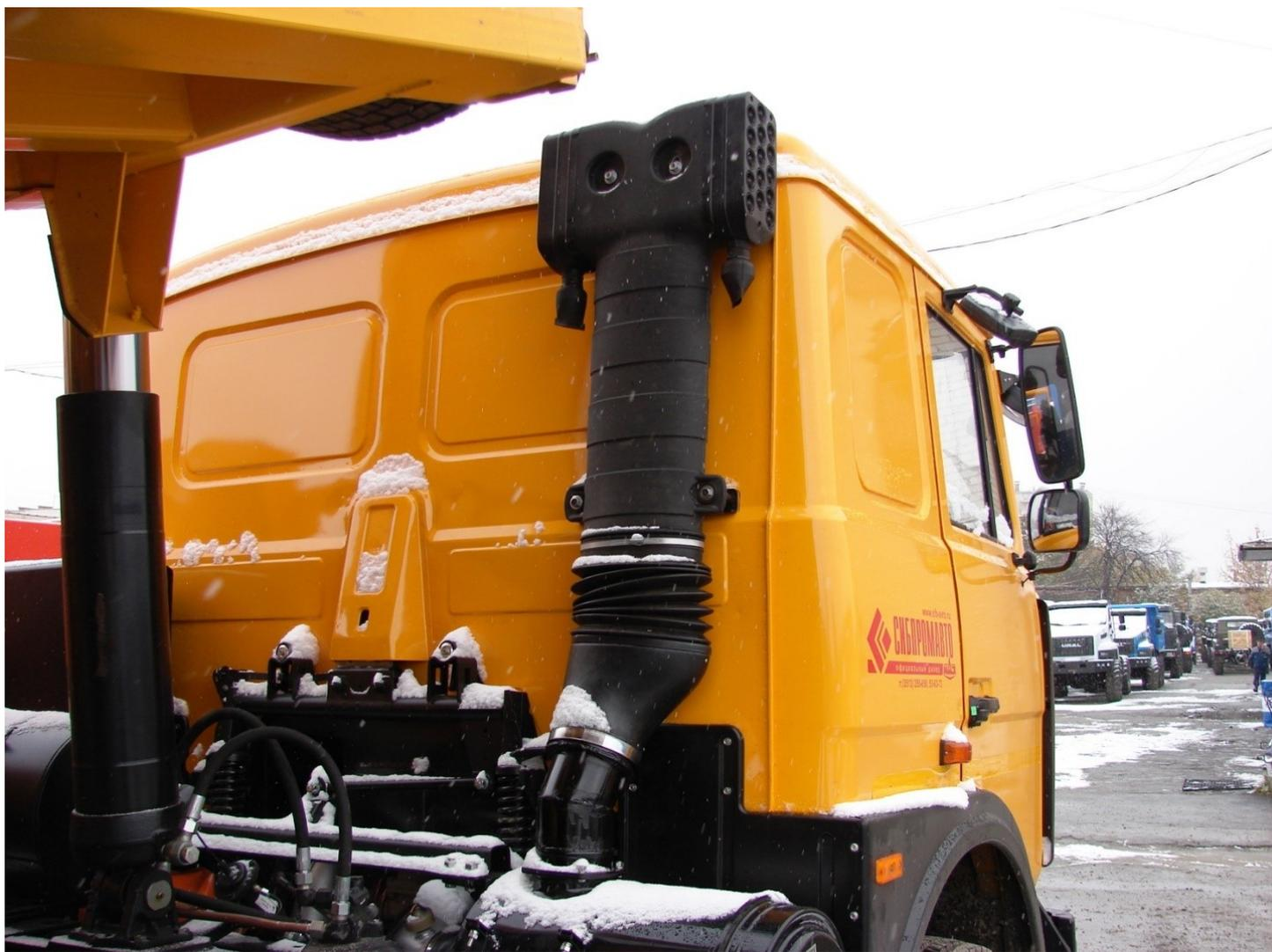
**Автомобильные воздухоочистители циклонного типа «Циклон»** применяются на транспорте. Например, на грузовых автомобилях [МАЗ](#), [КАМАЗ](#), БелАЗ и др. - предварительная очистка воздуха, поступающего в [двигатель внутреннего сгорания](#) происходит в «циклоне», затем полная очистка производится в инерционно-масляном или сухом [воздушном фильтре](#).
