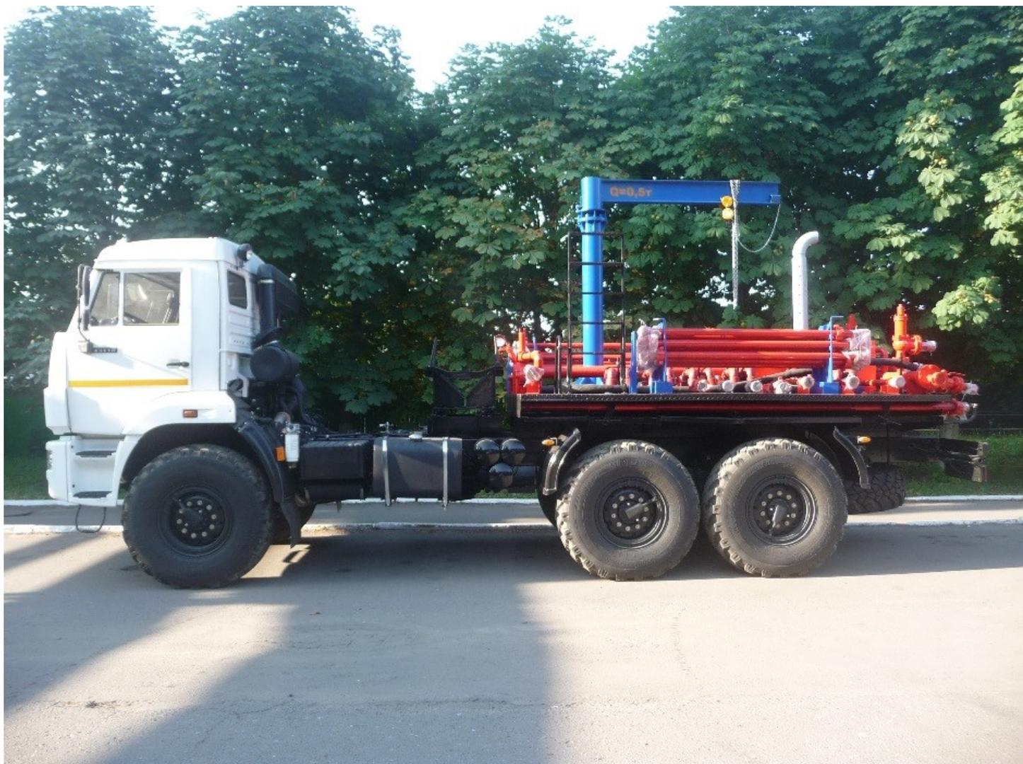
Установка блока манифольда БМ70/32 предназначена для обвязки насосных агрегатов между собой и с устьевой головкой при цементировании нефтяных и газовых скважин, гидравлическом разрыве пластов и гидропескоструйной перфорации, в условиях холодного ( $I_2$ ) в умеренного макроклиматических районов по ГОСТ 16350-80.
