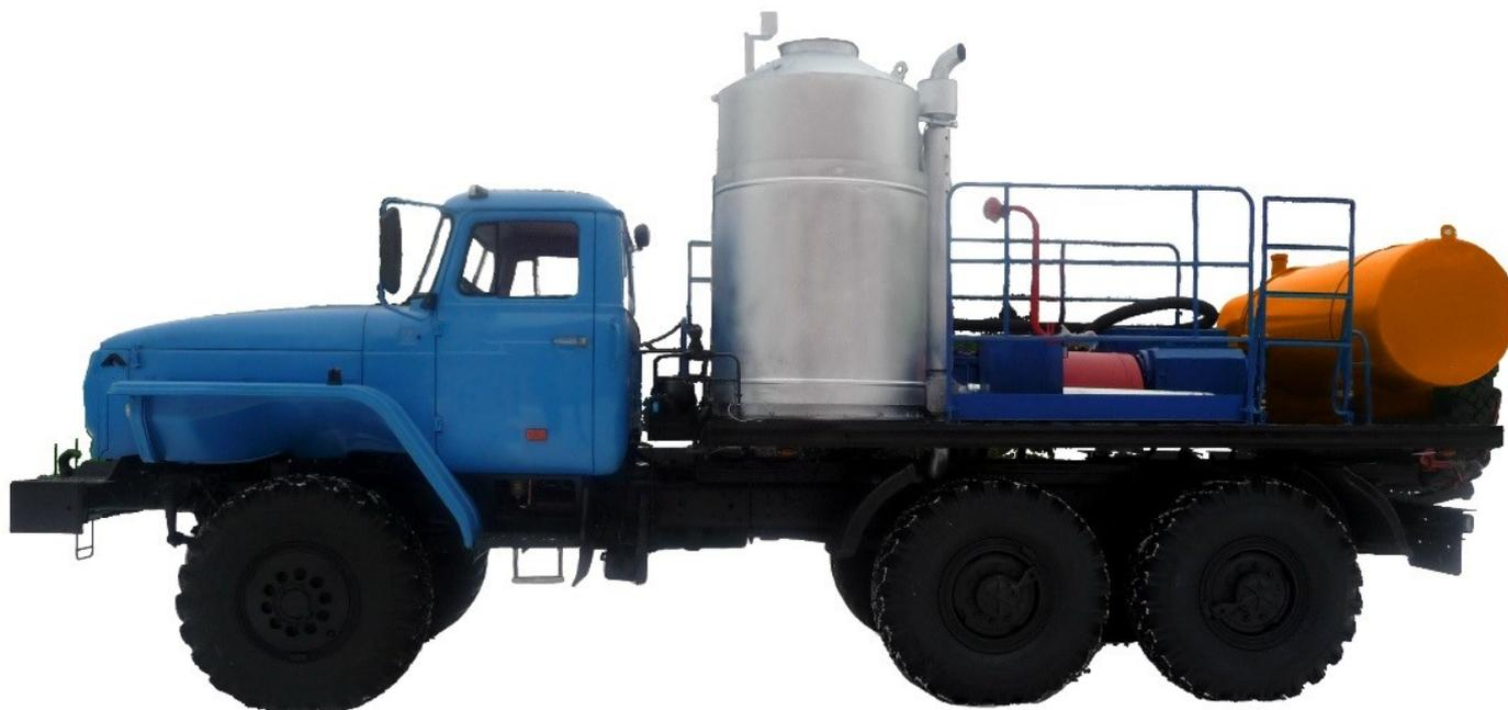
Агрегат АДПМ-12/150 предназначен для депарафинизации скважин горячей нефтью, а также для других технологических операций, где требуется подача продавочной жидкости под высоким давлением в условиях холодного и умеренного макроклиматических районов. Наличие технологических и вспомогательных трубопроводов дает возможность быстро подключать агрегат к скважине и емкости с нефтью. Агрегат легко запускается в работу, нефть нагревается до установленной температуры за 20 мин. с момента пуска.
