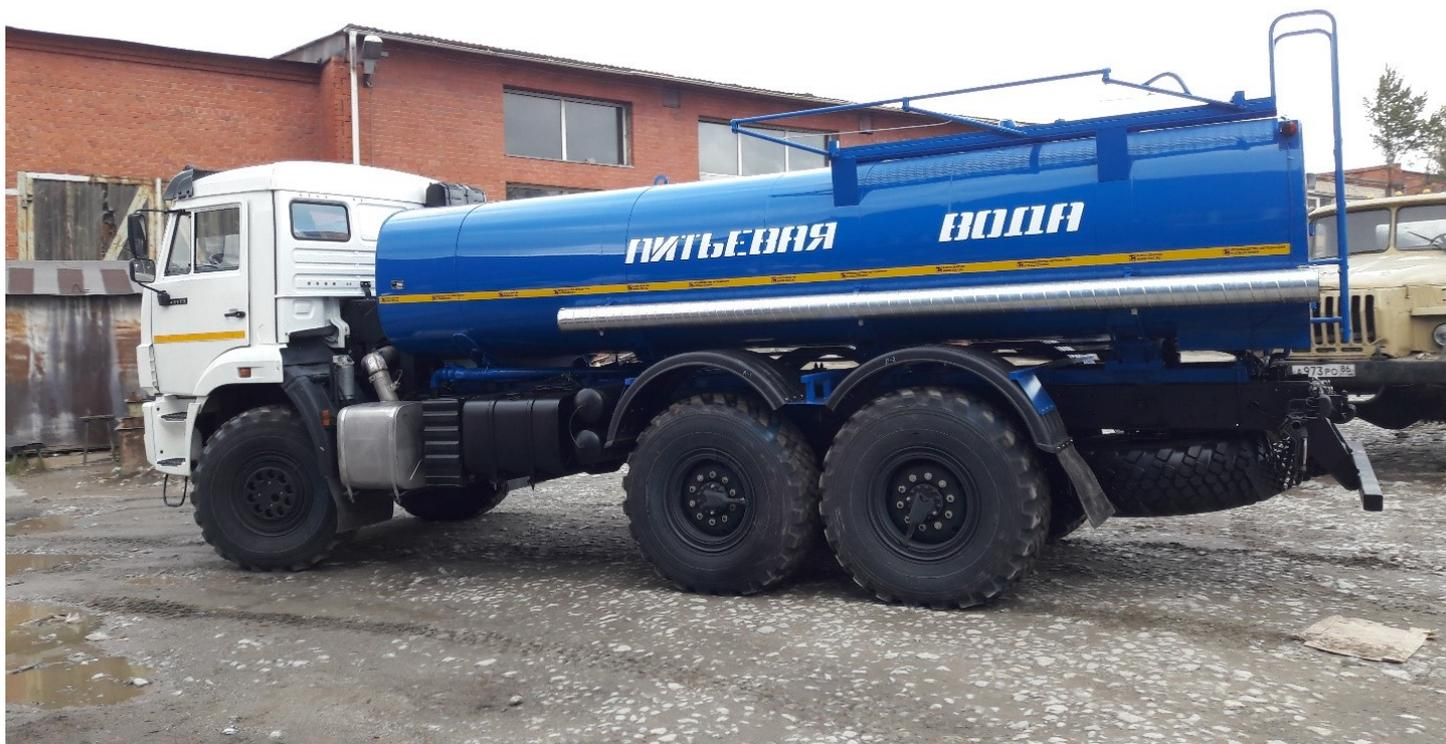
**Цистерна для воды АЦПТ-10 Камаз 43118 предназначена для транспортирования и кратковременного хранения пищевых жидкостей.**
