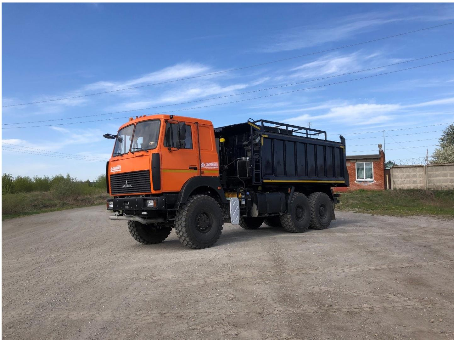
Самосвал-шламовоз построен на шасси МАЗ 6317F9-570-051 с максимальной массой 33,15 т и распределением нагрузки на переднюю ось 7,15т и на заднюю тележку 26т.
