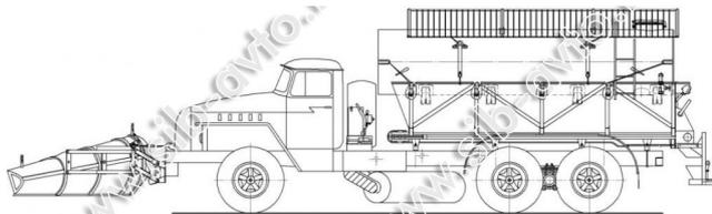
Машина для всесезонного содержания дорог МД-432-С на базе Урал-4320-1912-41 предназначена для очистки усовершенствованных дорожных покрытий от свежес выпавшего снега (сгребание, подметание, удаление с проездов) и распределения по поверхности дорог материалов и специальных реагентов при зимнем содержании дорог. В летний период машина используется для подметания, мойки, поливки дорожных покрытий, а также для мойки прилотовой полосы.
