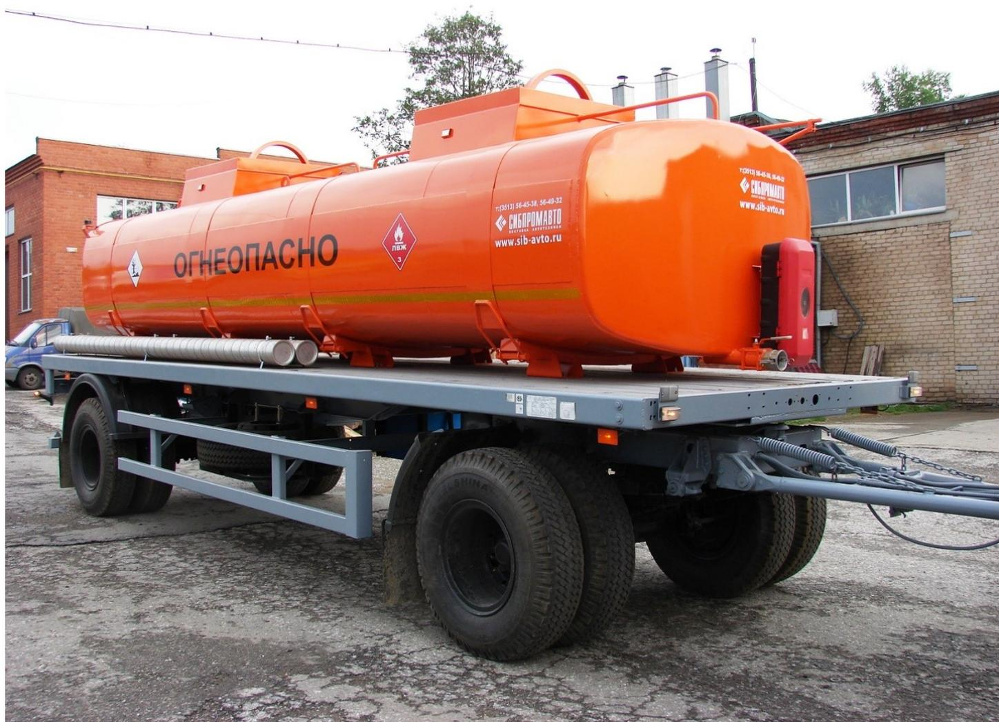
Стальной корпус имеет чемоданную форму сечения. Для снижения силы гидроударов на днища при изменении скорости движения прицепа оснащен **волнорезами**. Для исключения образования «воздушных мешков» при заполнении цистерны топливом в верхних углах корпуса цистерны установлены **воздухопроводные трубки**. В нижней части емкости прицепа имеется **отстойник** для сбора имеющейся в топливе влаги и механических примесей.
